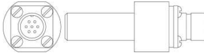
Рисунок А.5 - Внешний вид блока ДТНВ-1
