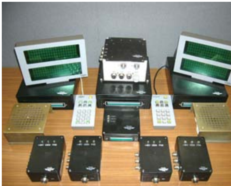
Рис. 1. Внешний вид блоков системы автоведения (КАУД)
