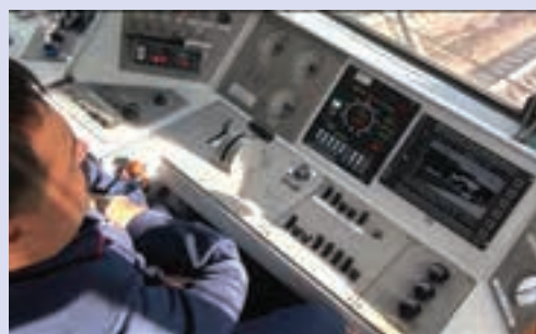
Машинист Макиевский в кабине ведущего электровоза ЗЭС5К который следует в составе соединенного грузового поезда на участке Хабаровск–Ружино в режиме автоведения
