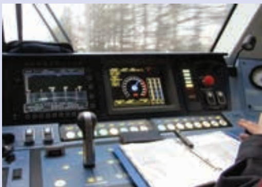
В кабине электровоза ЭП20 следующим в режиме автоведения на скорости 200 км/час
